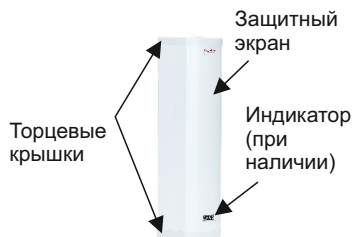
Рис. 2 – Основные элементы рециркулятора 1-115 М, 1-115 МТ, 1-130 М, 1-130 МТ, 2-115 М, 2-115 П, 2-115 МТ, 2-115 ПТ, 2-130 М, 2-130 П, 2-130 МТ, 2-130 ПТ (вид спереди)
